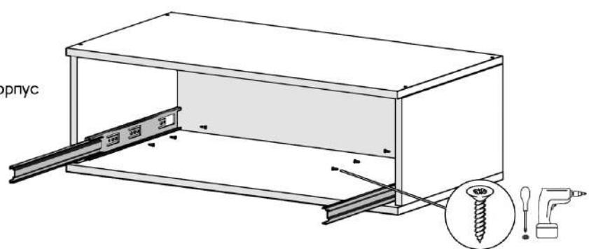
2. Установка направляющих на ящик саморезами в самой нижней его части
